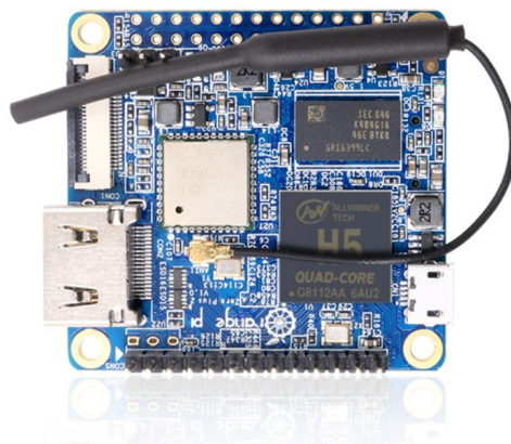
Figura 7 – Placa Orange PI Zero Plus 2 com H5
